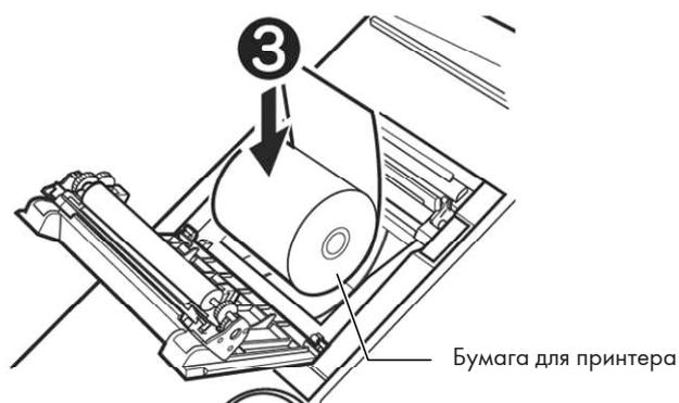
3. Установите бумагу торцом кверху и выступом наружу, затем зафиксируйте её, захлопнув крышку принтера до появления щелчка. Если крышка будет не полностью закрыта, бумага может замяться.
