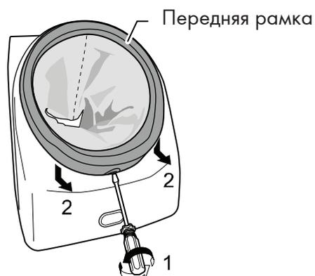
1. С помощью плоской отвертки ослабьте винт.
